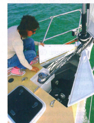
Guindeau électrique de série, baille à mouillage profonde pour ranger les pare-battage.
