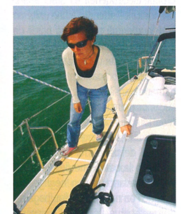
Une circulation aisée et très sécurisée par les longues et solides mains courantes sur le rouf.
