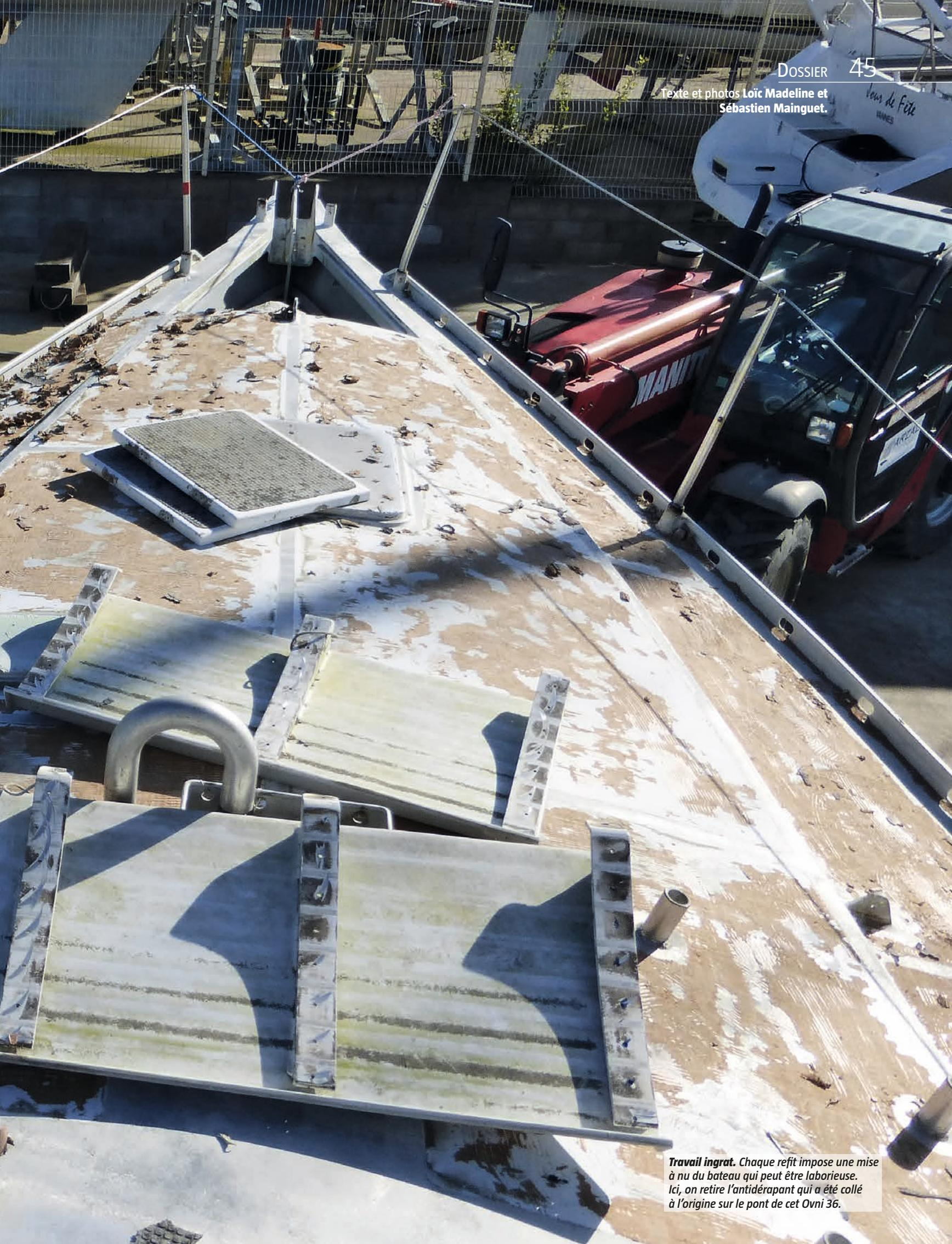
*Travail ingrat. Chaque refit impose une mise à nu du bateau qui peut être laborieuse. Ici, on retire l'antidérapant qui a été collé à l'origine sur le pont de cet Ovni 36.*
